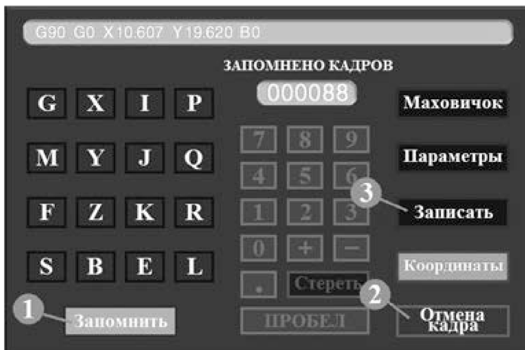
Рис. 5. Окно режима «ручное управление» системы ЧПУ «DiaHa-CNC»
