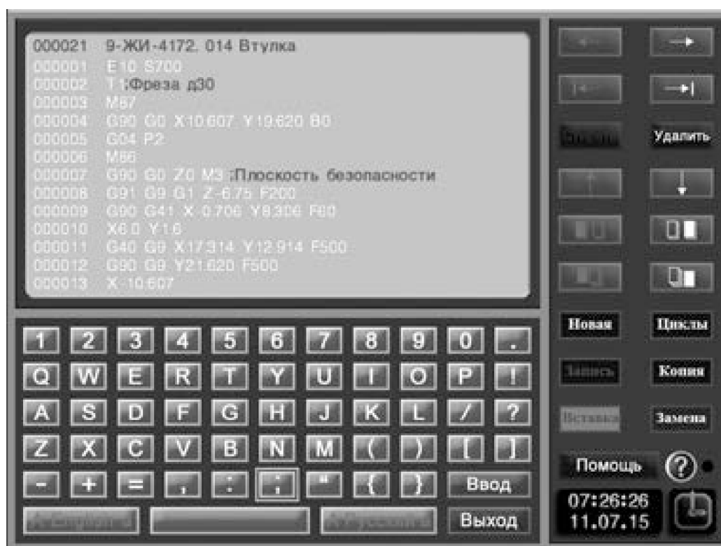
Рис. 2. Вид экрана встроенного редактора управляющих программ системы числового программного управления «ДиаНа-CNC-СМ» (сенсорный монитор)
