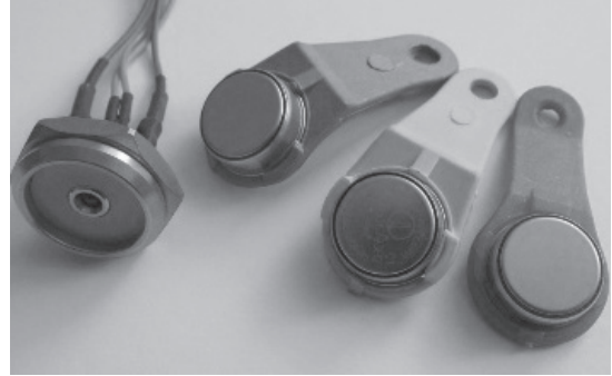
Рис. 5. Ключи iButton для санкционированного доступа к СЧПУ
