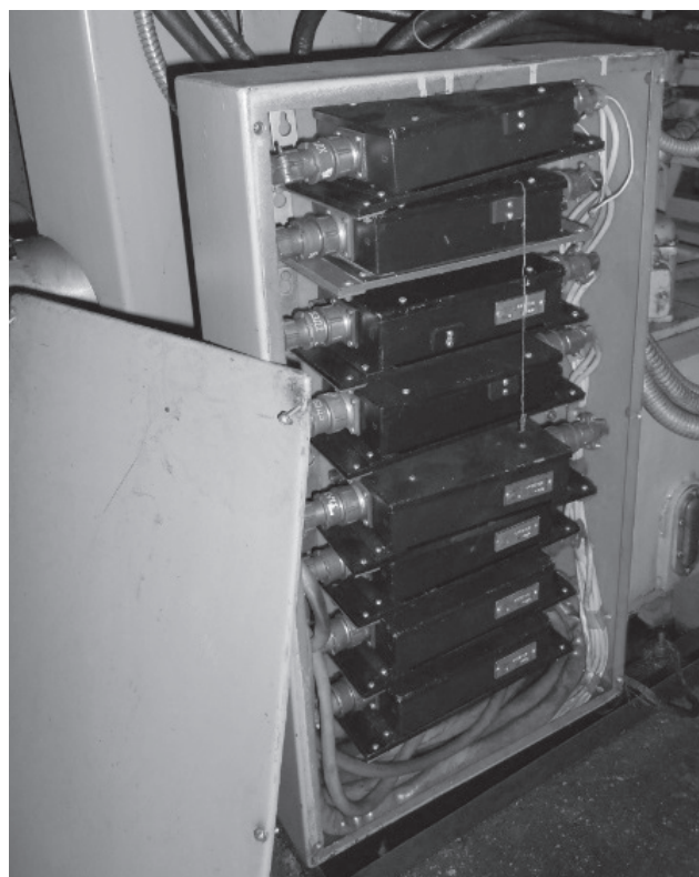
Рис. 13. Блоки согласования датчиков обратной связи многооперационного станка BM501ПМФ4
