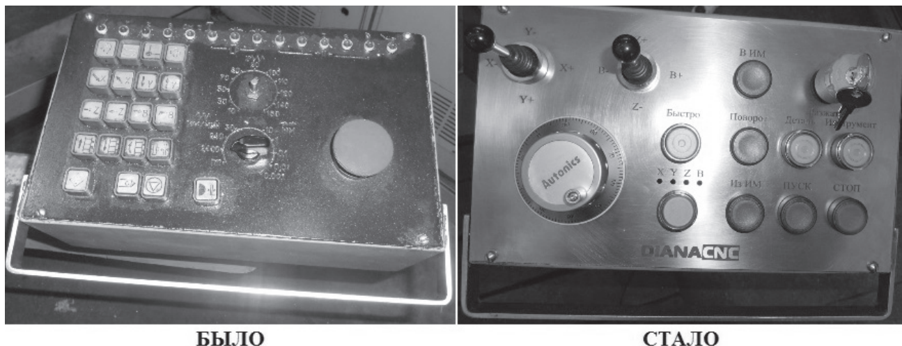
Рис. 9. Модернизация станка VM501ПМФ4: замена станочного пульта оператора
